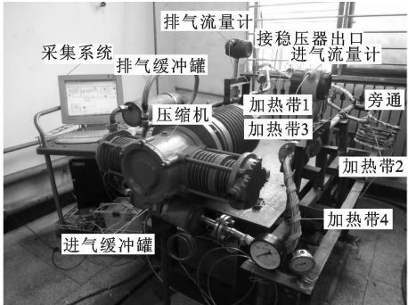
(b)压缩机及数据采集装置
